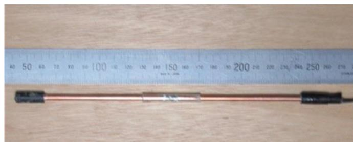
図3、本実験用に製作した、超小型線形ダイポール型の DC 電場センサー。直線状に配置された2本の円筒状のセンサー素子（直径3 mmφ、長さ10 cm）は互いに GND に対して電氣的平衡が保たれているため、その検出精度は極めて良好と考えられる。
